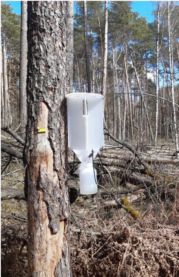
Ryc. 1. Pułapka IBL-5 zastosowana w Puszczy Kampinoskiej (fot. D. Marczak). [Fig. 1. IBL-5 trap used in Kampinos Forest (photo by D. Marczak)].
